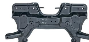
18 14 119 Motorträger für Fzg. ohne Partikelfilter Diesel + Benzin
