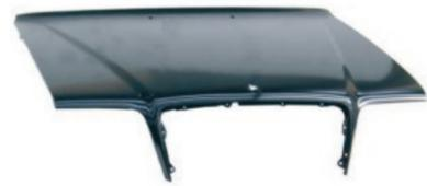
16 13 000 Motorhaube für Fahrzeuge mit Stern in der Motorhaube
