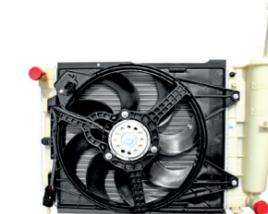
834 05 10 Frontmodul kpl. +AC inkl. Lüfter/Kühler Kondensator/Widerstand 1.2 8V; +AC
