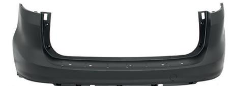
14 67 055 Stoßfänger hinten grundiert; kein PDC mit Zughakenabdeckung
