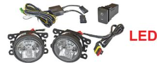
44 64 488 SATZ LED-Nebelscheinwerfer / LED-Tagfahrlicht mit „E“-Prüfzeichen gem. ECE-Regelung R87 + R19; 2 Hochleistungs-LED pro Leuchte (je 1 LED pro Funktion); inkl. Halter und Kabelsatz mit H11-Stecker; Einbauanleitung ist im Lieferumfang enthalten. Maße: B 90 mm, H 90 mm, T 93 mm
