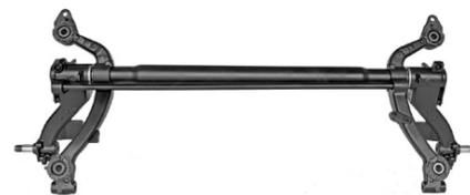
42 25 719 Hinterachse nur Kombi für Scheibenbremse
